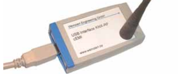
Interfaccia USB per KNX-RF. Foto: Weinzierl USB Interface for KNX-RF Photo: Weinzierl
